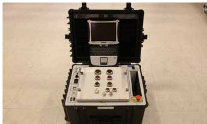
Общий вид МПК-24 с переходными панелями Заказчика
