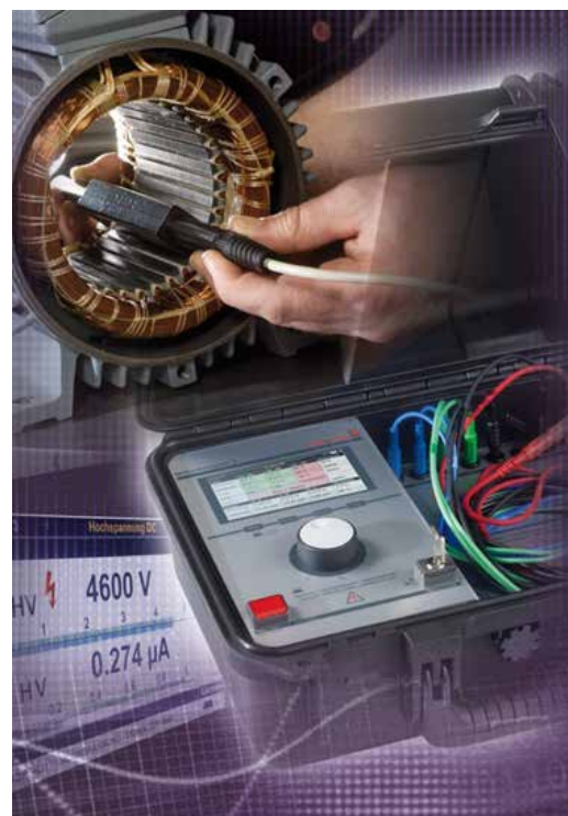
Определение КЗ витков в обмотке статора по секциям
