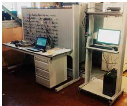
Оснастка для испытаний, выполненная в виде стола со светодиодной подсветкой.
